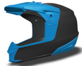
새로운 카메라 마운트, 백 피스, 마우스피스를 파란색으로 강조하여 렌더링한 CAD 헬멧 디자인
