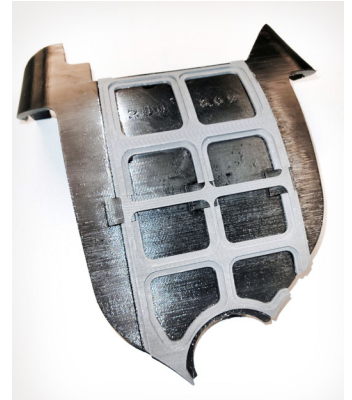
탄소 섬유 프레임(회색)과 TPU 뒤판이 있는 3D 프린팅된 엠블럼 위치 지정 고정 장치.
