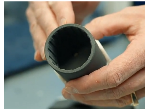
스플라인과 매끄러운 프린팅 표면 마감을 보여주는 3D 프린팅된 수공구 소켓입니다.
