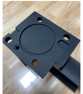
부품 수집기의 장착 플랜지는 FDM Nylon-CF10 소재로 달성할 수 있는 표면 마감을 보여줍니다.
