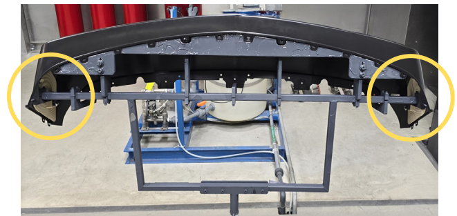
페인트 고정 장치의 부품에 설치된 3D 프린트 마스크의 두 가지 예시(강조 표시됨).
