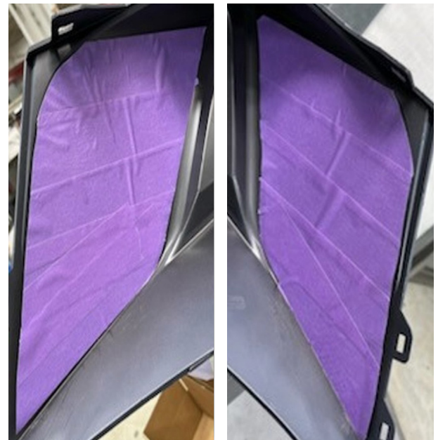
3D 프린트된 페인트 마스크에 적용된 테이프는 마스크 효과를 확인합니다.
