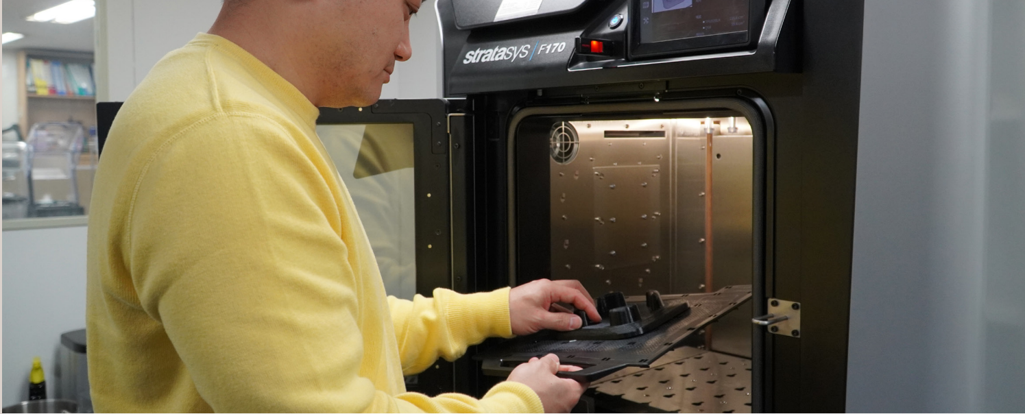
우일산업은 Stratasys F170 3D 프린터의 소재 다양성으로 ABS-M30과 TPU92A 소재를 통해 목업과 워킹 프로토타입을 제작합니다.
