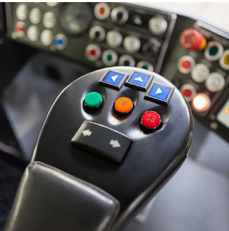
제어 시스템을 위한 3개의 버튼이 추가된 3D 프린터로 제작된 암레스트
