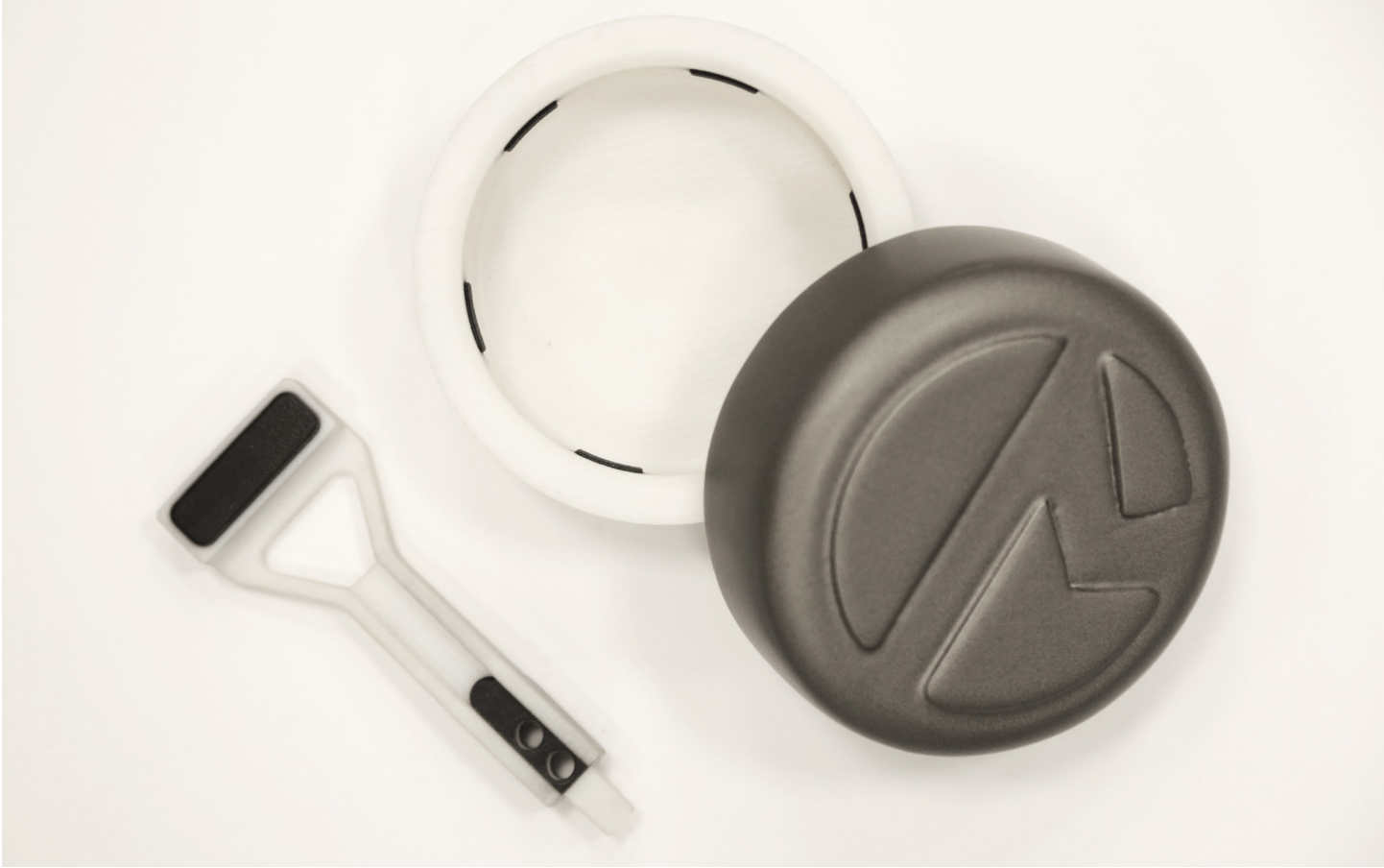
그리퍼(왼쪽)와 패키징 뚜껑(오른쪽) - Stratasys PolyJet 기술을 사용하여 3D 프린터로 제작했습니다. 복합 재료 3D 프린팅을 사용하여 흰색 부품과 검은색 고무 모사 재질 그리핑을 한 번에 프린팅했습니다.
