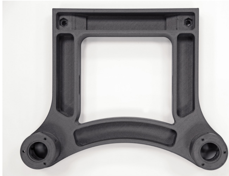
3D 프린터로 제작된 부품으로 로봇 포장 시스템의 제품 핸들링에 사용됩니다. FDM Nylon 12CF 재료를 사용하여 제작했습니다.
