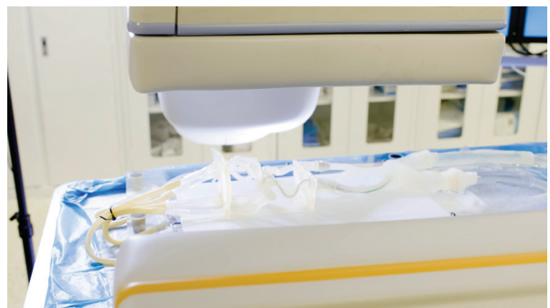
3D 프린터로 제작된 혈관 테스트 모델을 통해 의료 기기 설계자와 엔지니어는 장치 성능에 대한 피드백을 얻을 수 있습니다.
