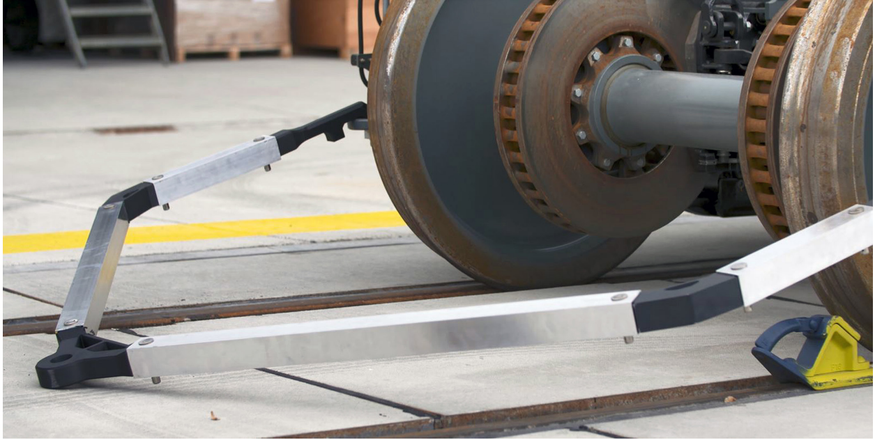
Siemens 모빌리티는 현재 Fortus 450mc를 사용하여 몇 시간 만에 각 보기에 맞춤형 특수한 톨을 제작합니다.
