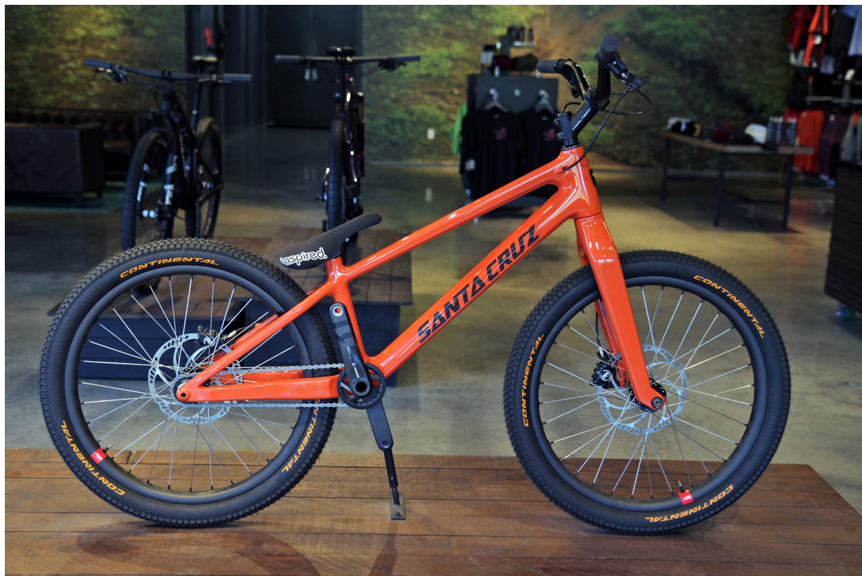
완성된 “Danny의 자전거”는 3D 프린팅 툴링으로 제작된 파트로 개발되었습니다.
