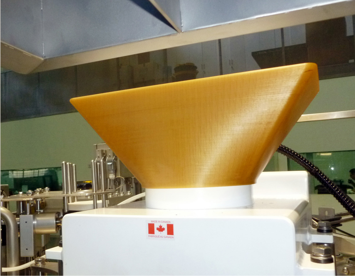
이 3D 프린팅된 식품 포장 기계 교체 파트는 Fortus 450mc 3D 프린터에서 ULTEM™ 1010 수지 재료를 사용하여 3D 프린팅되었습니다.
