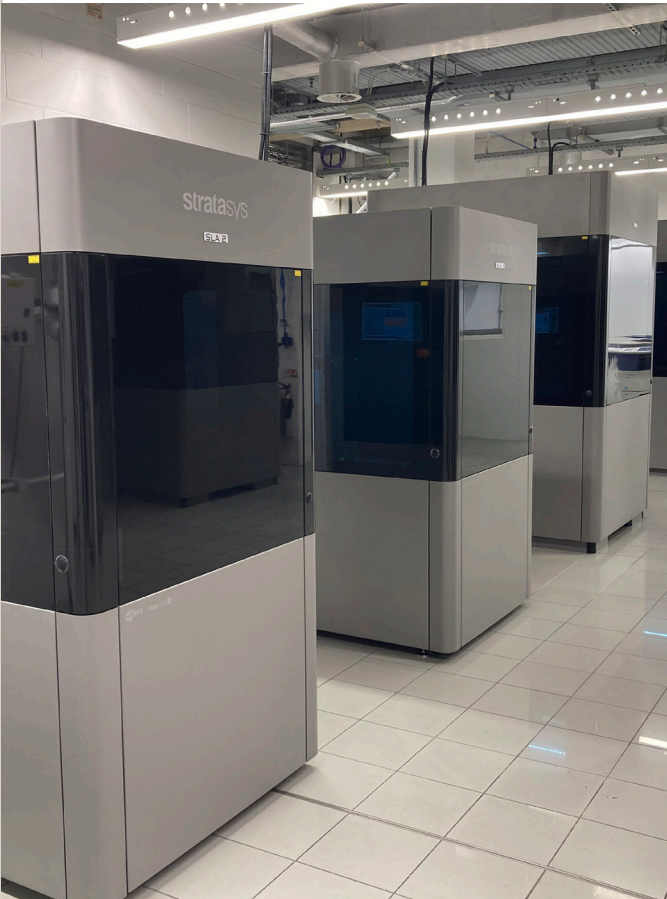
Stratasys Neo800 3D 프린터를 사용하여 McLaren F1 팀 매년 약 9,000개의 광경화 수지 조형 부품을 생산합니다.
