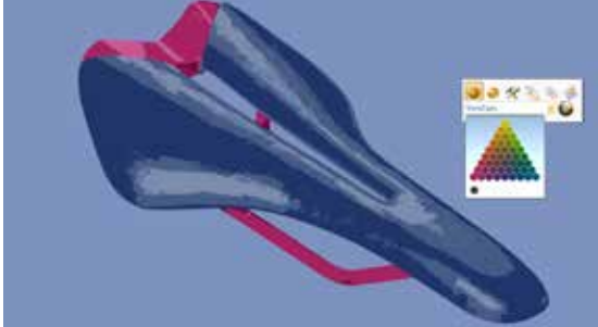
그림 8: 사용자가 셀을 클릭하면 오브젝트 스튜디오 소프트웨어가 선택된 3종의 기본 재료를 기반으로 복합재료 옵션을 자동으로 보여줍니다.
