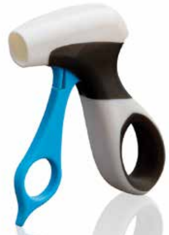
그림7: 디지털 ABS Plus는 의료 기구의 디자인 검증 프로토타입에서 매우 중요하게 사용됩니다. Agilus30 역시 수술용 프로토타입의 더 나은 그림감을 위하여 검은색 오버몰딩으로 이용되었고 컬러 핸들을 별도로 프린팅했습니다. Digital ABS Plus는 기존 Digital ABS 대비 충격강도가 신장되어 가능성이 향상되었습니다.
