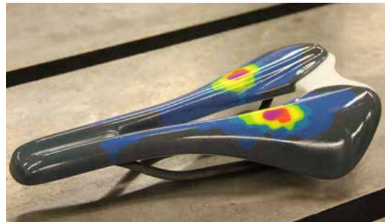
그림 3: 사진의 컬러 모델은 유한요소분석(FEA) 데이터를 3D 프린팅으로 보여 줍니다.
