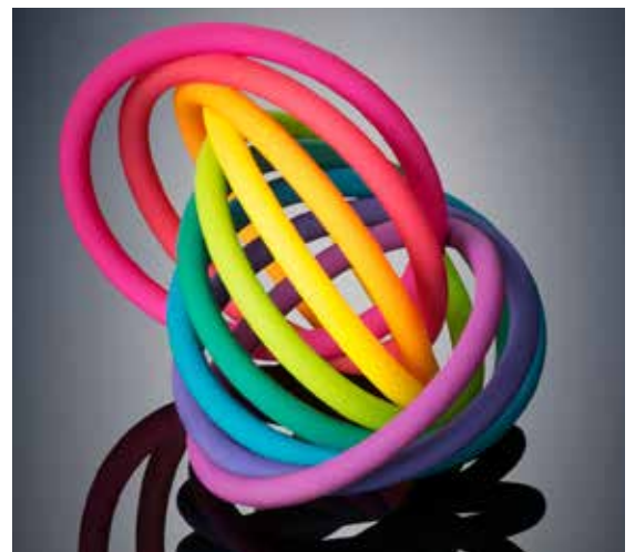
그림 5: 사진 속의 컬러 인터로킹 링은 청록색, 자홍색, 노랑색 팔레트를 이용해 한번의 작업으로 3D 프린트되었습니다.
