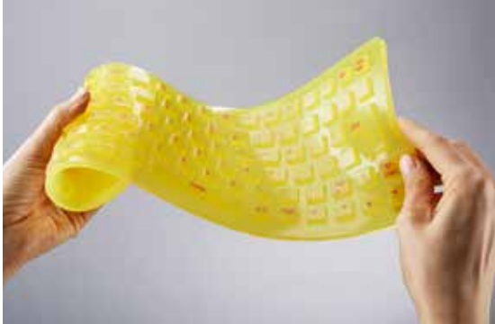
그림 6: Connex3에서 투명 고무 유사성 재료와 노랑색과 자홍색 색상을 혼합해 한 번의 작업으로 사진 속의 유연하고 다재로운 색상을 가진 키보드를 3D 프린트했습니다.
