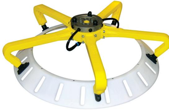
Digital Mechanics는 적층 제조를 통해 내부 진공 채널이 있는 그리퍼를 다시 제작하여 작업을 지연시키는 외부 호스 5개를 제거했습니다.
