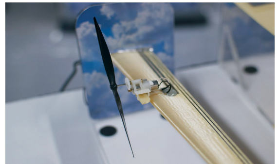
3D로 프린팅된 부품과 전자 장치로만 제작된 오로라의 날개
