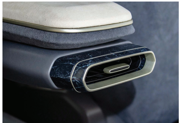
Stratasys 3D 프린터로 제작한 대리석 재질의 3D 프린팅 에어컨 디퓨저.
