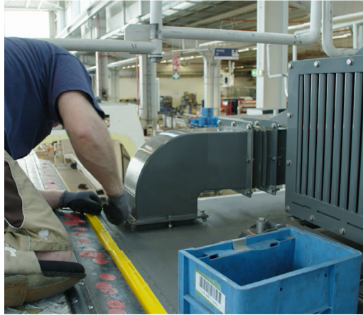
ULTEM™ 9085 수지를 사용하여 3D 프린팅한 맞춤형 통기 시스템의 최종 결과물
