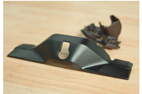
3D 프린팅 카메라 마운트 브래킷과 뒤편의 고정 클립.
