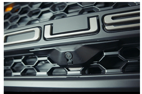
완성된 카메라와 3D 프린팅 브래킷은 F-150 트럭 그릴에 장착되었습니다.
