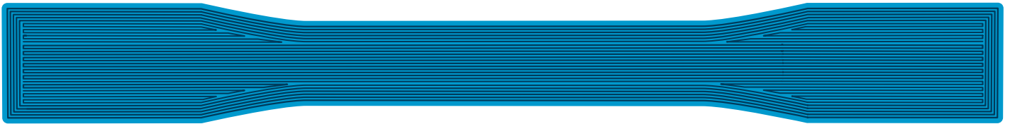
그림 6 - 목 영역 내에 단방향 툴패스가 있는 D638 인장 쿠폰의 툴패스.
