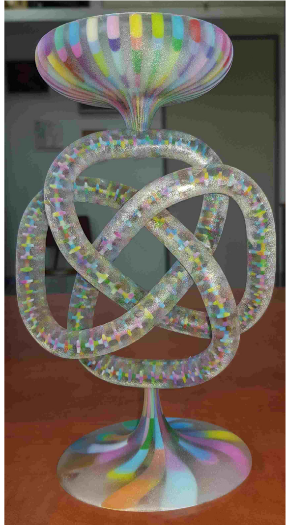
Voxel Print로 슬라이스되고 유색의 미세 요소와 반투명 VeroClear 재료로 덮여 있는 '성배' 3D 프린팅 모델.
