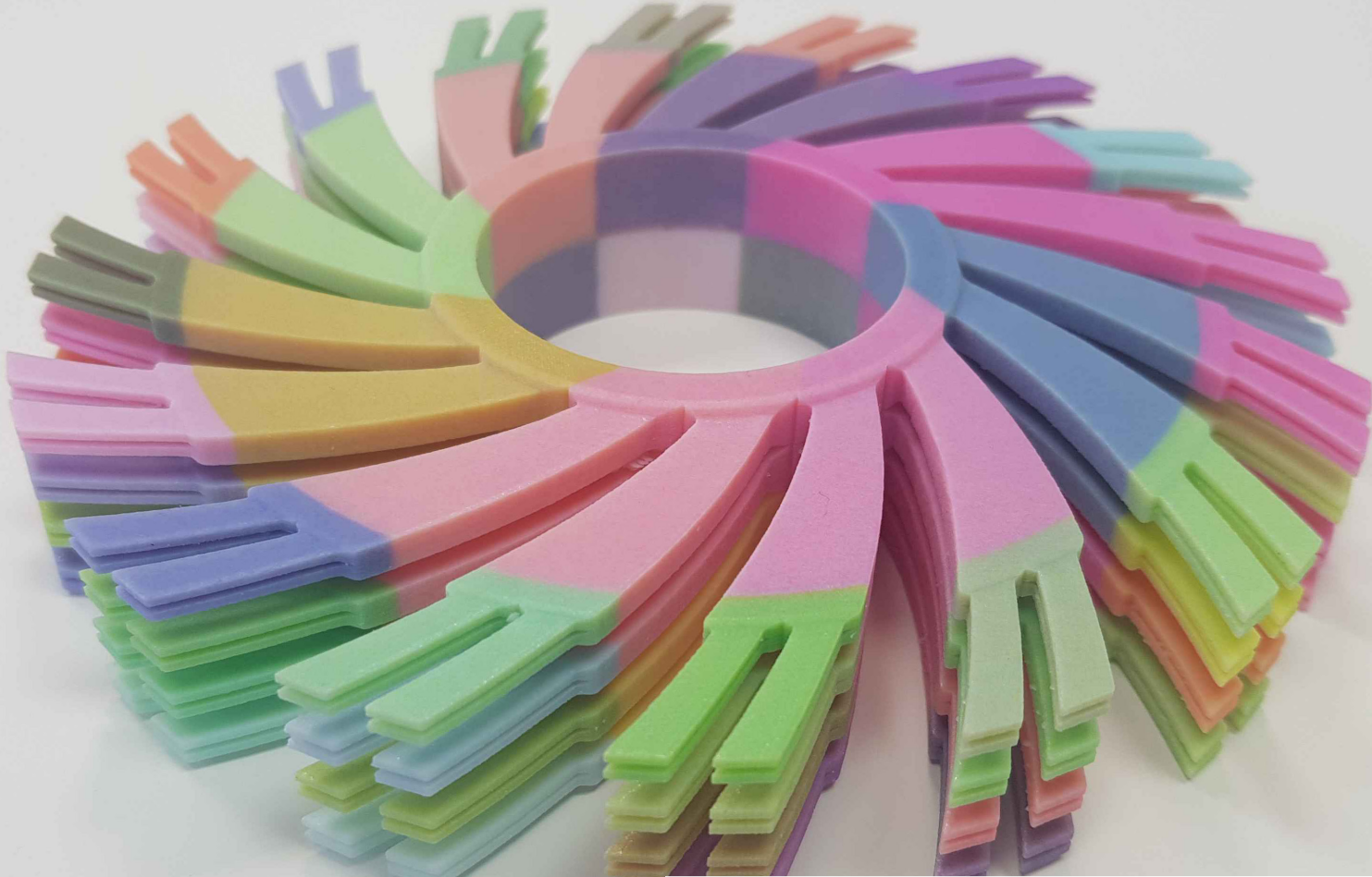
방열판(수동형 열교환기) 모델은 J55에서 3D 프린팅되었으며, 미세 요소는 다양한 색상으로 표시되었습니다.
