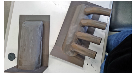
알루미늄 몰드 제작 시 3주나 걸리지만, 3D로 프린팅한 흡기 매니폴드의 새크리피셜 몰드(Sacrificial Mold)는 불과 5시간 만에 완성되었습니다.
