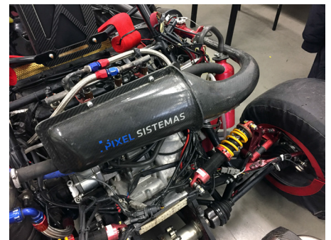
최종 탄소 섬유 흡기 매니폴드는 공기 흐름의 효율을 높이고 트랙 성능을 향상시키기 위해 매끄러운 곡면 마감을 이용합니다.
